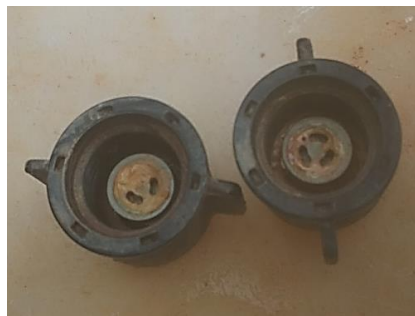
Figura 3 – Bicos ATR 1,5 entupidos devido mistura de produtos
