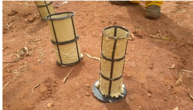
Figura 1 – Filtros congestionados devido misturas indevidas
